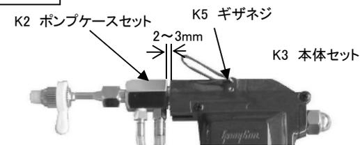
振動等でK2ポンプケースセットがK3本体セットから外れた場合は、付属の2.0L棒ハンドルでK5ギザネジを締めてください。締める位置は水を噴射しながらポンプケースセットを出し入れし、音が小さく、水の出方のよいところで締めてください。(又は、以前のギザネジの傷跡を参考にしますと簡単に出来ます。年数が経ったものは隙間を上図よりも狭くしてください。)
