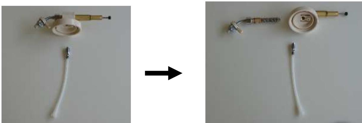
3. 付いたままのノズルー式とポンプを外すため、ポンプを傷つけないように布を巻き、ノズルー式のスパナ取付けナット (6) 部分より 17 スパナで外す。(布を巻いたポンプはスパナで回らないように持つ。)
